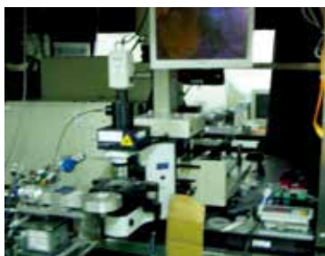
T 64000微光譜量測系統 (今年新增XY平面定位掃描功能)
